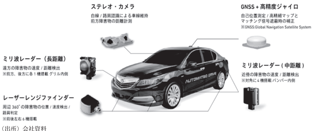
図 20 ホンダの高速道路での自動運転試験車両のシステム構成
