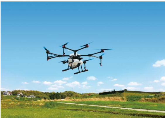
図表3-2 スマート農業を導入した農業機械 (左:農業用ドローン、右:GPS付き無人トラクター)
